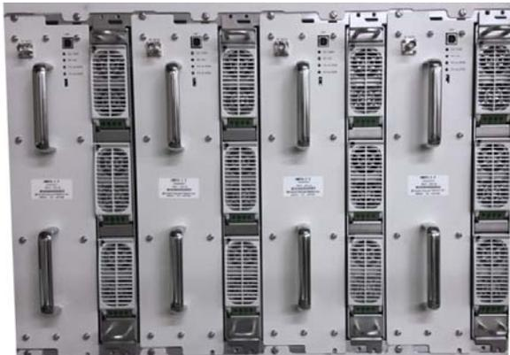
**Fig. 36: 4 Amplificadores en Paralelo con Fuentes de Alimentación Asociadas**
