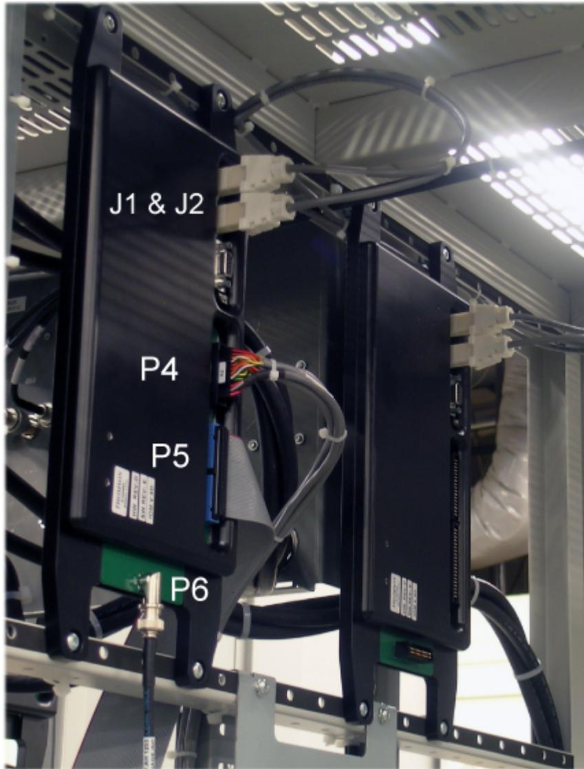
A/C Distribution Module      Remote Interface Module
